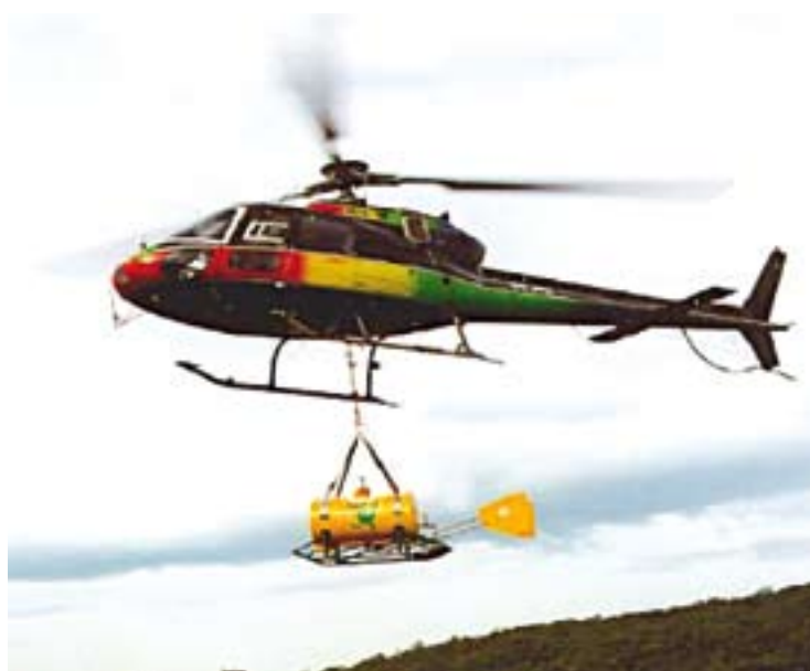
Helikopter s uređajem za spaljivanje
